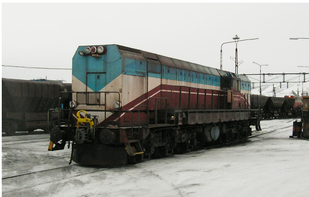
MTAB diesellok T46 nr 4 på Kiruna sjöbangård den 12 mars 2004. Loket är byggt av Nohab 1973 och ursprungligen levererat till LKAB. Loket är numera ombyggt till T46-GPC-utförande. (Foto: Peter Berggren)
