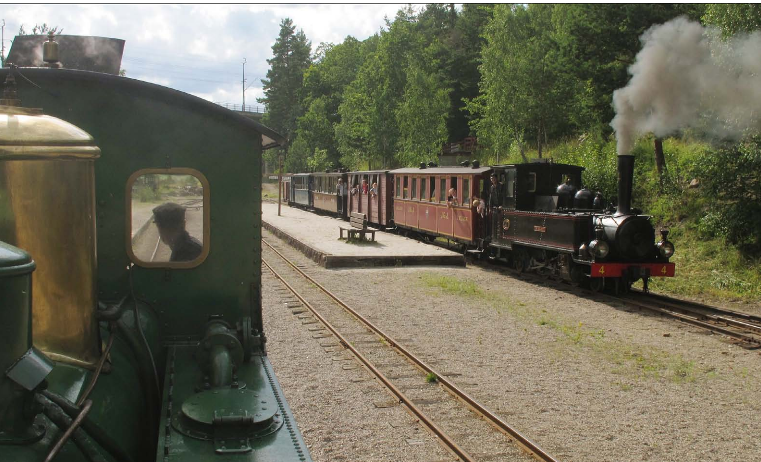
TVå ångtåg möts på Läggesta station på Östra Södermanlands Järnväg (besöksmål 35). Järnvägen är smalspårig med 600 mm spårvidd.
